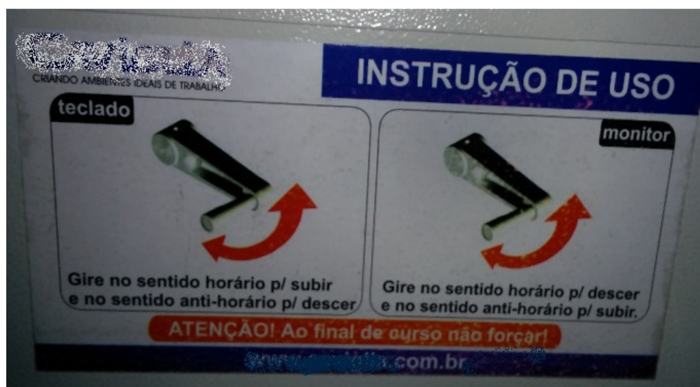
Figura 05 – Instrução de uso do mecanismo de ajuste de altura das superfícies do teclado e monitor. Fonte: Arquivo pessoal, 2015.
